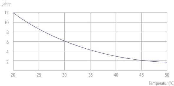
Die Lebensdauer der Batterien ist stark abhängig von der Umgebungstemperatur, dabei liegt die optimale Betriebstemperatur bei 20 °C. Höhere Temperaturen verringern die Brauchbarkeitsdauer enorm. Oberhalb einer Temperatur von 40 °C besteht das Risiko des „thermal runaway Effektes“, was eine Zerstörung durch Brand oder Explosion zur Folge hat.
