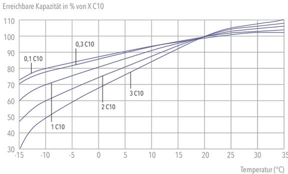
Die Kapazität der Batterien ist stark abhängig von der Umgebungstemperatur, dabei liegt die optimale Betriebstemperatur bei 20 °C. Tiefere Temperaturen verringern die verfügbare Kapazität enorm und verlängern die Wiederaufladezeit. Unterhalb einer Temperatur von -8 °C besteht das Risiko des Gefrierens des Elektrolytes, was jedoch auch vom Ladezustand abhängt. Dies hat eine Zerstörung des Akkumulators zur Folge.
